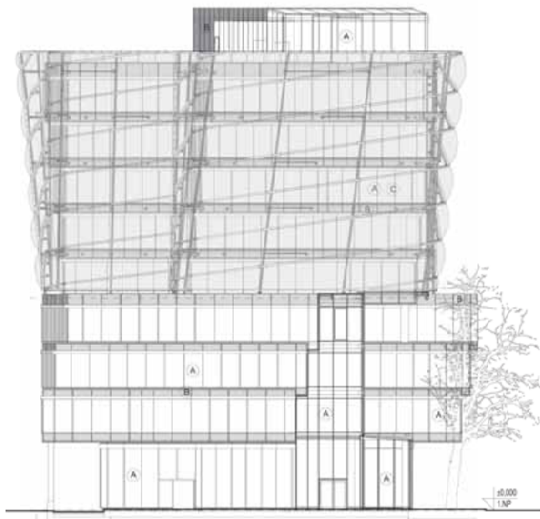
Jižní fasáda s membránou ETFE – solární kolektor South façade with ETFE membrane – solar collector
